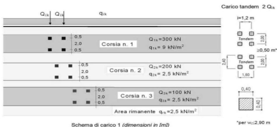
fig.6 – Schema di Carico 1 – NTC 2018 - carico Tandem + Distribuito ( carico congestionato).
