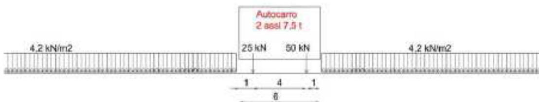
fig.11 – Schema di Carico "LEGGERO" – CDS - carico Tandem 7,5t + Distribuito.
