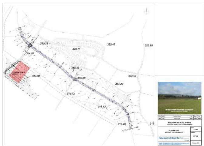
Per lo studio idraulico è stato eseguito il rilievo topografico del Flumini Mannu per il tratto significativo a monte ed a valle del sito di impianto della stazione di rete di progetto in prossimità dell'attraversamento stradale.
